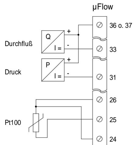
Bild 2: Passive Stromeingänge, statt einem Temperaturmessumformer wird ein Pt100 verwendet.
