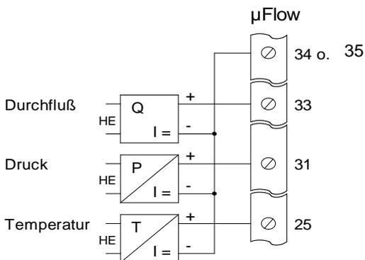
Bild 5: Aktive Signale, die Meßumformer werden extern gespeist.
