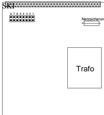
Bild 11: Netzteilplatine mit den Jumpern für die Frequenzeingänge
