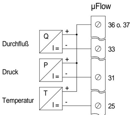
Bild 1: Passive Stromeingänge, der µFlow speist die Meßumformer.
