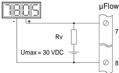
Bild 7: Externer Zähler mit Spannungseingang. Der Vorwiderstand  $R_v$  sollte im Bereich zwischen 1 bis 10  $k\Omega$  liegen.
