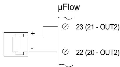
Bild 8: Analogausgang, Ausgänge sind aktiv, es wird keine externe Spannungsquelle benötigt. Die max. Bürde beträgt 500  $\Omega$
