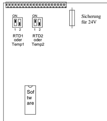
Bild 12: Ausgangsplatine mit DIP-Schaltern für Temperatureingänge
