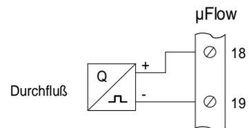
Bild 6: Der Durchflussaufnehmer kann auch mit einem Pulsausgang verarbeitet werden, der Stromeingang bleibt dann unbeschaltet
