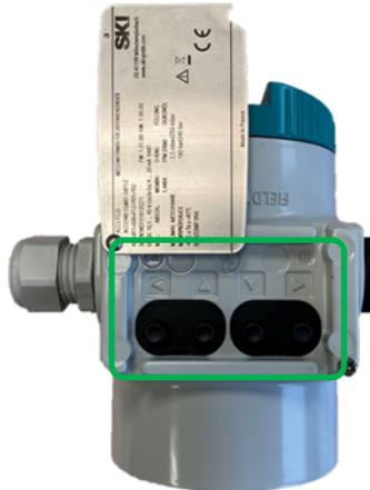
Abbildung 8: geöffneter Messumformer
